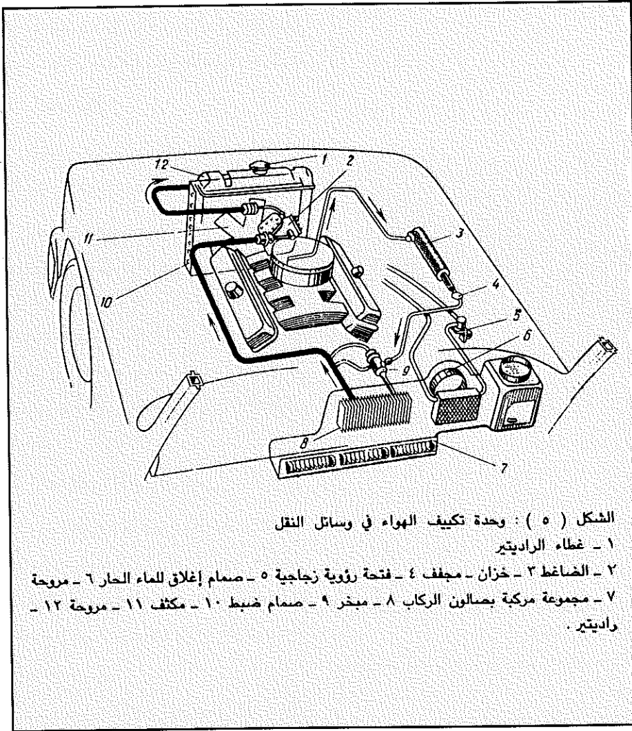
(الشكل - 5) : وحدة تكييف الهواء في وسائل النقل
