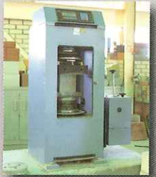
يجري اختبار المكعب لكل كمية لضمان الجودة
