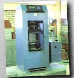
يجري اختبار المكعب لكل كمية لضمان الجودة
