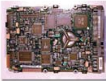
(الشكل - 2) صورة تبين اللوحة المنطقية للقرص الصلب
