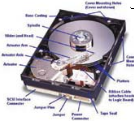
(الشكل - 1) الأجزاء المادية للقرص الصلب الصفائح
